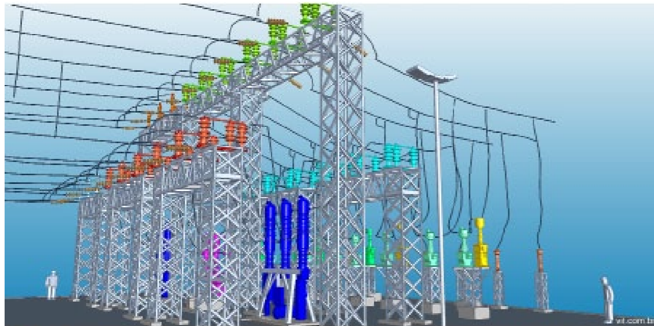
ChesF Modelagem de uma subestação 3D baseada nas nuvens de pontos do escaneamento a laser. Cadmatic Substation model based on point-cloud laser scanning reference file. CADMATIC
